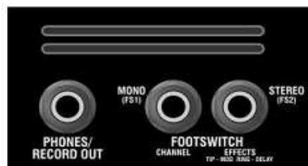
**23. Kanali:** koristite pojedinačne prekidače (Mono jack) nožni prekidač (Laney FS1 preporuka) prekidač izmedju kanala.
