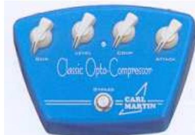
Dobrodošli u Vintage Opto-compressor, poznatiji kao optical compressor od dana kada su boje postale vazan faktor u zvuku. Optički kompresor izvršava gain gde se smanjuje kontrola sa svetlosnim izvorom u foto osetljivim čelijama. Sto je jače osvetljenje ima više kompresije.
