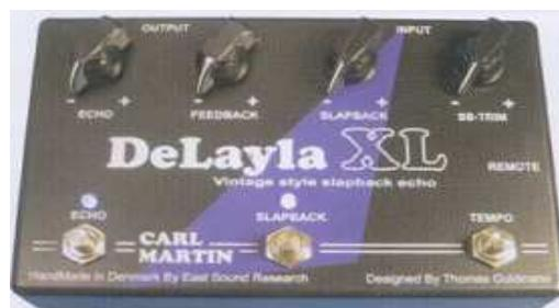
Slapback kontrolni taster kombinuje glavni delay sa drugom delay glavom. Pokret se koristi suprotno od kazaljke na satu za drugu delay glavu. Suprotno od kazaljke na satu favorizuje glavni delay.
